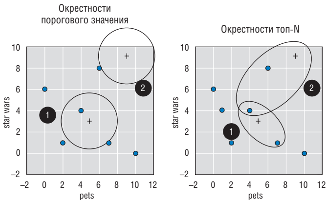
Рис. 8.7. Два способа нахождения окрестностей. Слева показано, как работает метод порогового значения. Вокруг активной точки рисуется круг (по крайней мере, в 2D), и все элементы внутри него будут являться соседями. Справа показан метод топ- N . Здесь уже соседи выбираются не по расстоянию, а набираются до нужного количества
