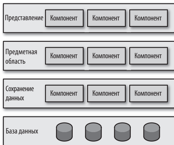
Рис. 4.5. Типичная слоистая монолитная архитектура
