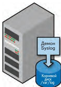
Рис. 9.2. Интерфейс демона Syslog с локальной файловой системой
