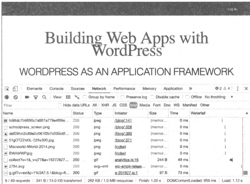
Рис. 14.1. Панель отладки браузера Chrome с открытой вкладкой Network
