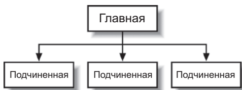
Рис. 15.1. Отношения между БД при репликации
