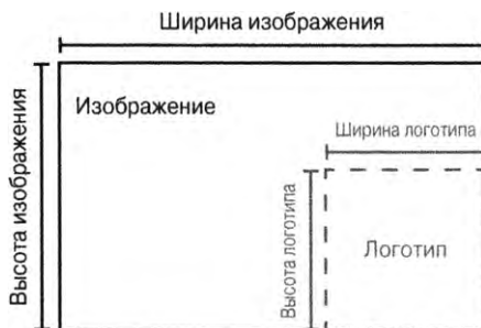
Рис. 19.12. Координаты левого и верхнего краев логотипа при его помещении в правый нижний угол изображения определяются разностью значений ширины/высоты изображения и ширины/высоты логотипа
