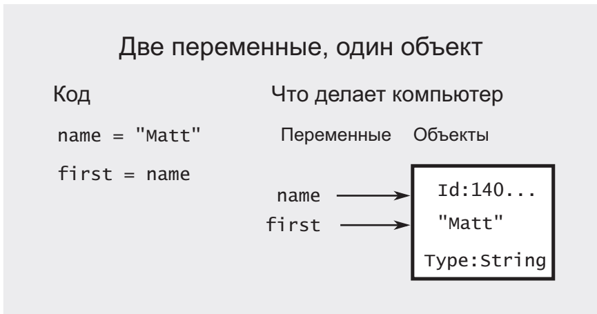
Рис. 7.1. На диаграмме показано, что происходит при связывании переменной с существующей переменной. Обе переменные указывают на один объект.
