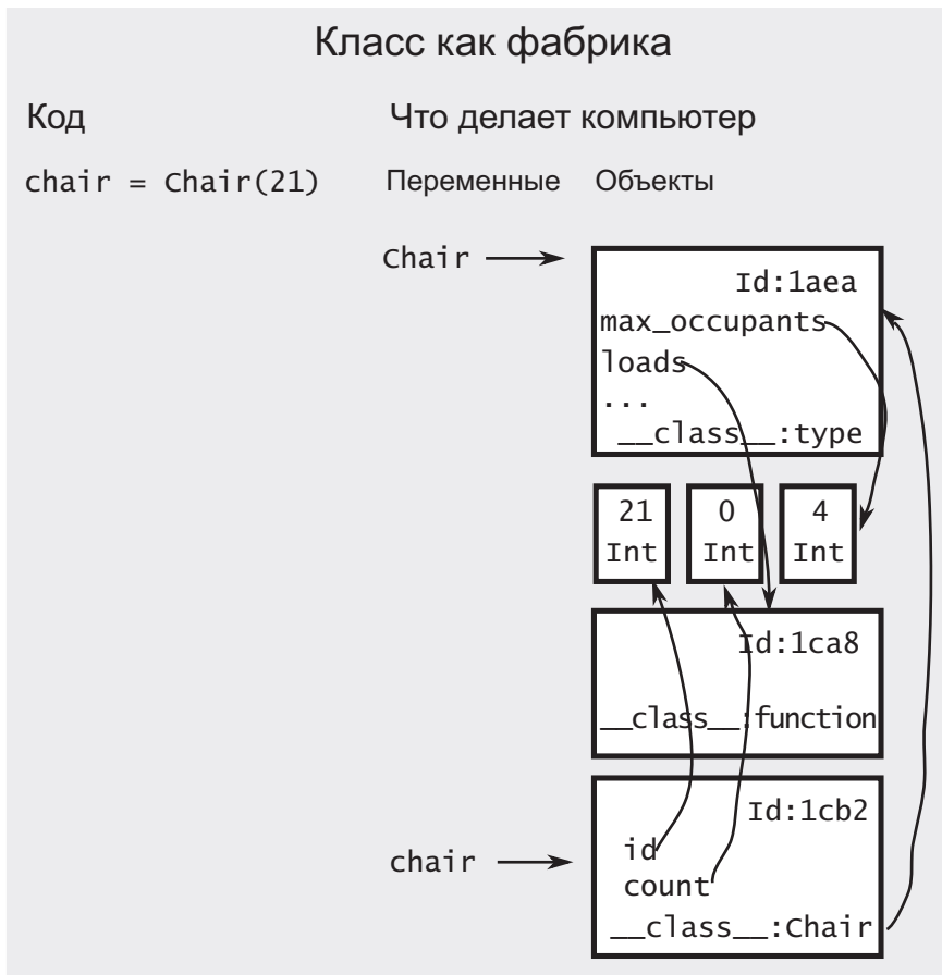
Рис. 21.4. Процесс построения объекта. При вызове конструктора «аист» — Python приносит конструктору «ребенка» — объект ( self ). У этого объекта установлен атрибут __class__ , но конструктор может свободно изменять экземпляр, добавляя новые атрибуты. Объект превращается в chair
