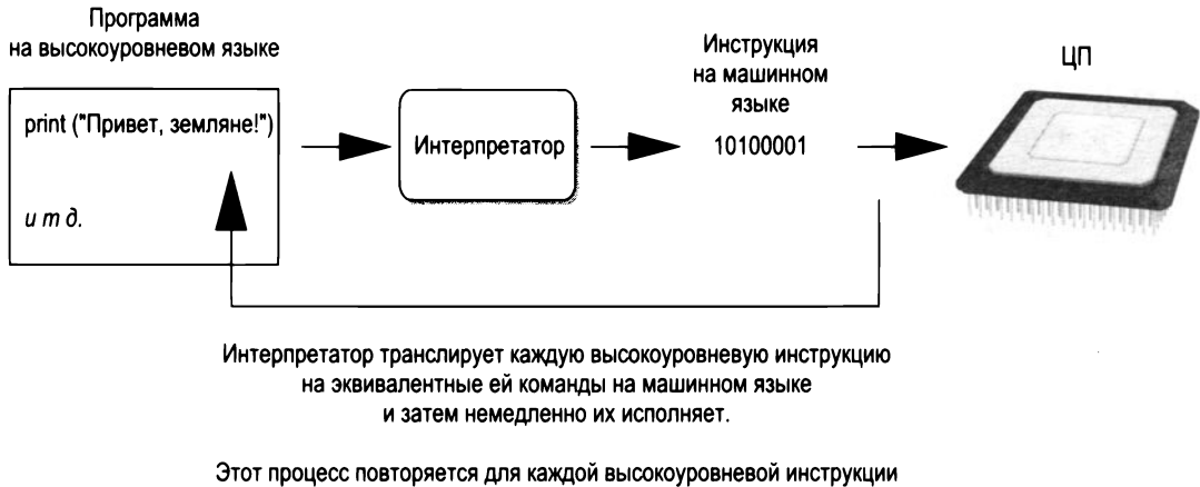
РИС. 1.19. Исполнение высокоуровневой программы интерпретатором
