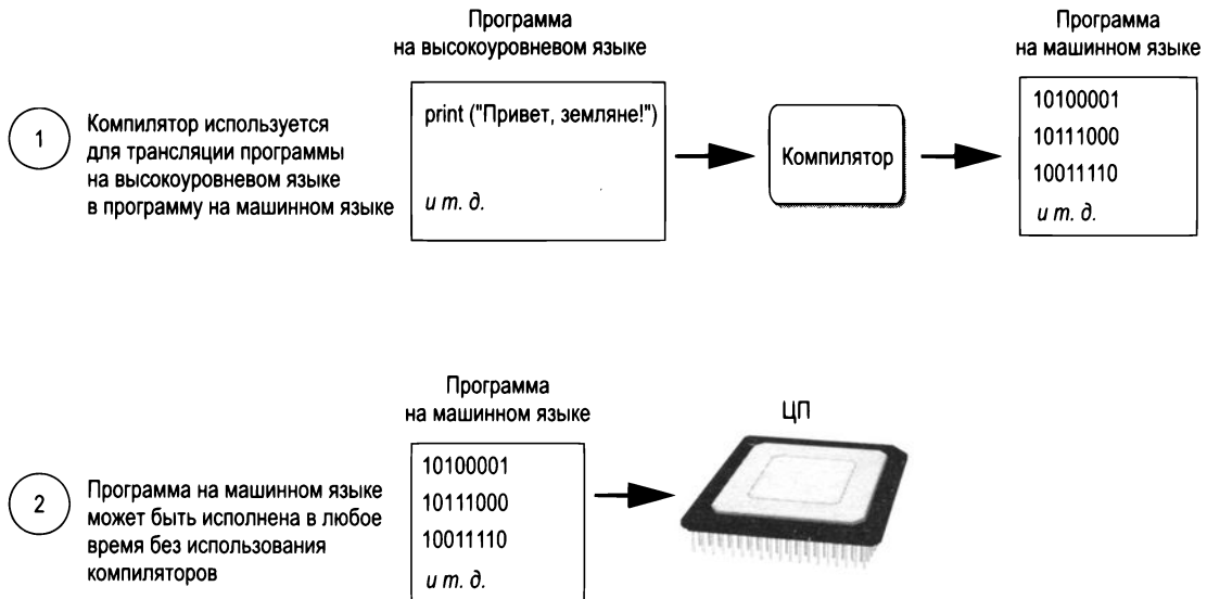
РИС. 1.18. Компилирование высокоуровневой программы и ее исполнение
