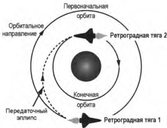
Рис. 14.8. Переход на нижнюю круговую орбиту с использованием гомановского перехода с орбиты на орбиту
