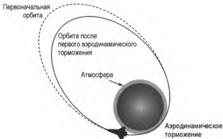
Рис. 14.22. Скругление орбиты с использованием атмосферы вместо ретроградного сжигания топлива
