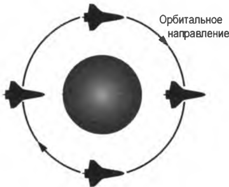
Рис. 14.3. Космические аппараты на орбите сохраняют прежнее положение, если только их не вынуждают к иному
