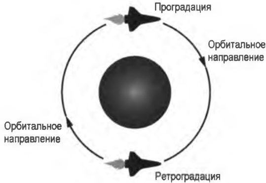
Рис. 14.4. Проградация и ретроградация определяются ориентацией носовой части космического аппарата относительно направления его движения вокруг тела, которое он облетает
