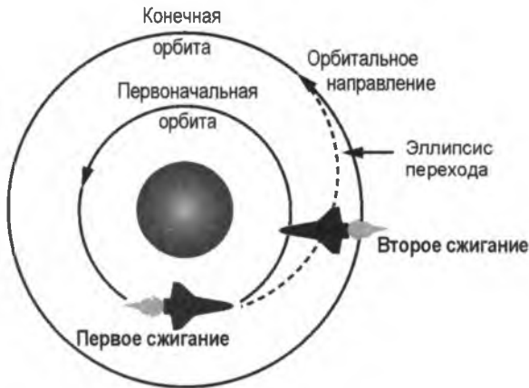
Рис. 14.9. Переход на более высокую круговую орбиту методом однотангенциального сжигания
