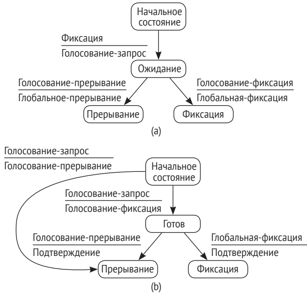
Рис. 8.30 ❖ а) Конечный автомат для координатора в 2PC; б) конечный автомат для участника
