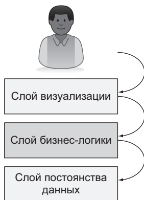
Рис. 6.7. Слой бизнес-логики определяет, когда и как данные читаются из слоя постоянства данных или пишутся туда
