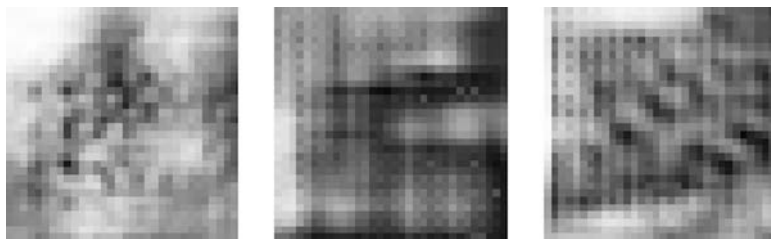
Рис. 8.17. Артефакты типа «шахматная доска», вызванные несовпадением размеров шага и ядра, из-за чего происходит неравномерный охват пространства пикселей: одна из многих тонкостей GAN, доставляющих хлопоты
