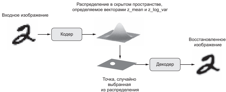
Рис. 8.13. Вариационный автокодировщик отображает изображение в два вектора, z\_mean и z\_log\_sigma , которые определяют распределение вероятности в скрытом пространстве, используемое для выбора точки для декодирования
