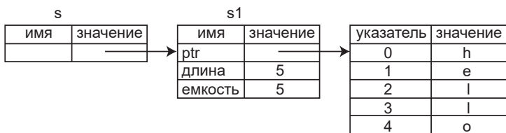
Рис. 4.5. Схема, демонстрирующая, как &String s указывает на String s1
