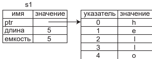
Рис. 4.1. Представление в памяти экземпляра типа String , содержащего значение «hello», привязанное к переменной s1
