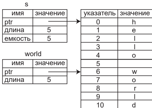
Рис. 4.6. Срез значения типа String , ссылающийся на часть значения
