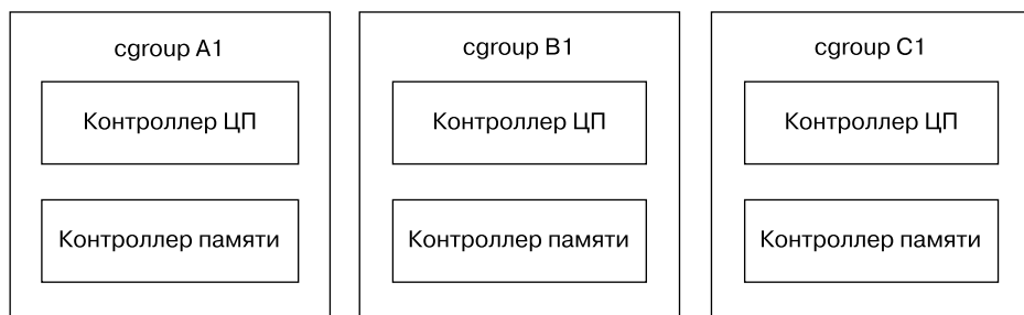
Рис. 8.2. cgroups v2. Процесс может принадлежать только одной группе
