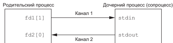
Рис. 15.8. Запись в стандартный ввод и чтение из стандартного вывода сопроцесса
