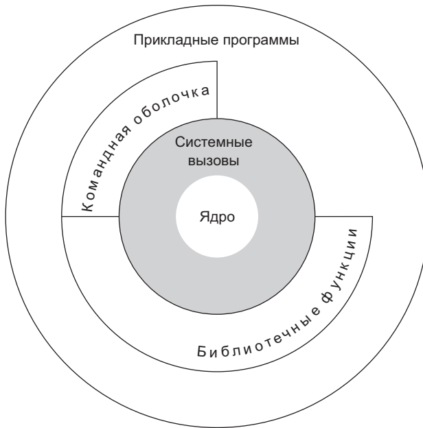
Рис. 1.1. Архитектура системы UNIX
