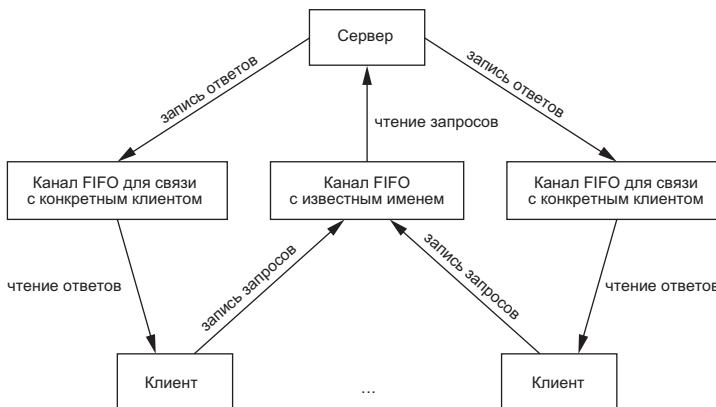
Рис. 15.12. Организация взаимодействий типа клиент/сервер с помощью каналов FIFO
