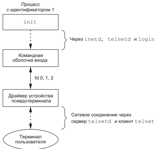
Рис. 9.5. Состояние процессов после входа пользователя через сетевое соединение
