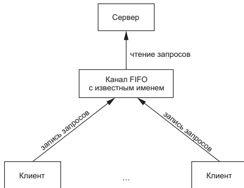
Рис. 15.11. Обмен данными между клиентами и сервером с помощью канала FIFO
