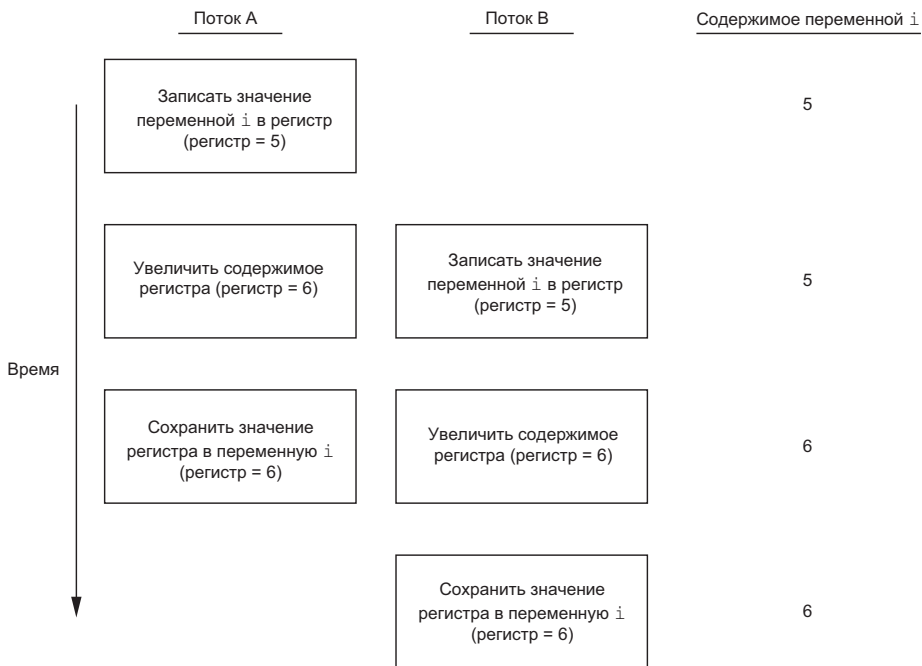
Рис. 11.4. Два несинхронизированных потока пытаются увеличить значение одной и той же переменной
