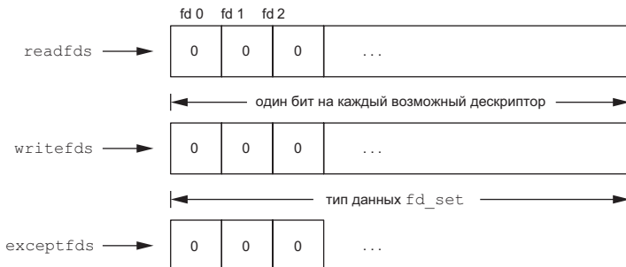
Рис. 14.6. Определение наборов дескрипторов для функции select
