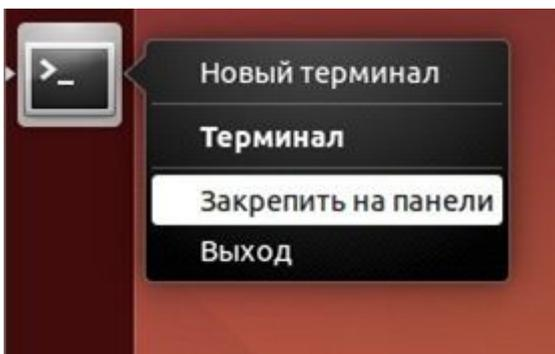
Правой кнопкой мыши на значке терминала в панели запуска появится меню, в котором выберем пункт «Закрепить на панели». Теперь терминал можно запускать непосредственно через панель запуска.
