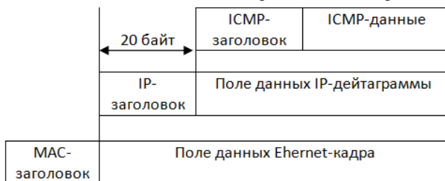
Рис. 3.8 - Схема вложения ICMP-пакетов в Ethernet-кадр
